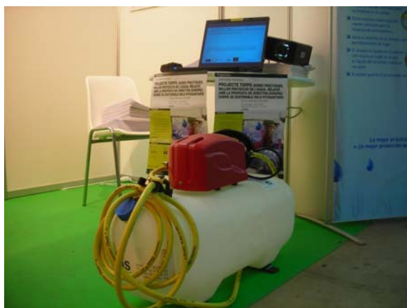
Nádrž na čistou vodu a postřikový násadec pro vnější očistu postřikovače (zdroj: UPC) (zdroj: DAAS, Jens Tønnesen)
